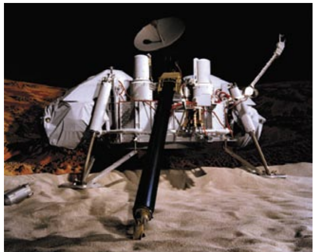
Un modello della sonda Viking 2 , con il braccio meccanico allungato per il prelievo dei campioni da sottoporre ad analisi biochimiche.
