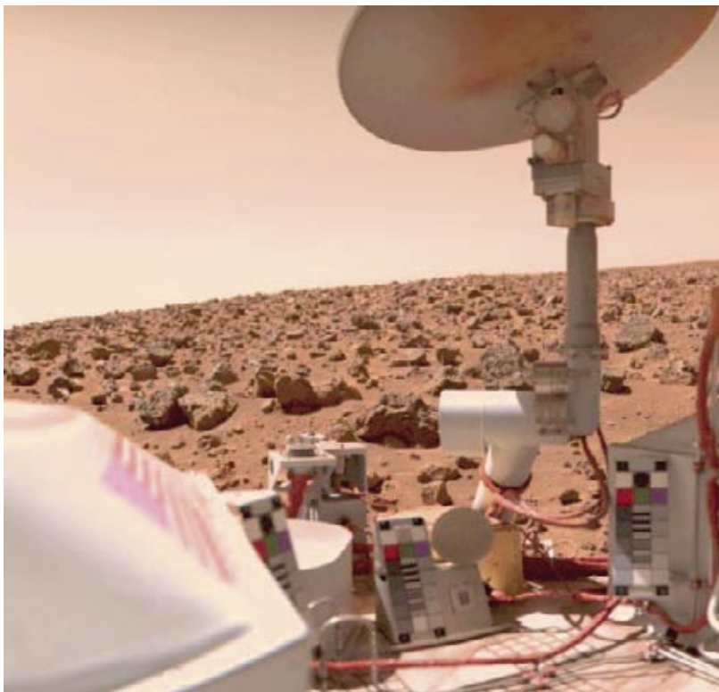
Panorama ripreso dal Lander della sonda Viking 2. In primo piano, l'antenna e alcune strumentazioni della sonda, parzialmente coperte dalla polvere marziana.
