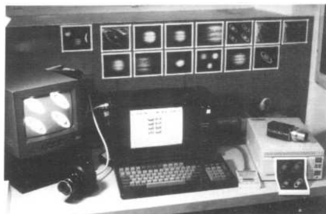
Fig. 1 - Veduta d'insieme della strumentazione elettronica utilizzata per la ripresa, l'elaborazione e la stampa delle immagini digitali. Al centro il personal computer AT 286 16MHz trasportabile.
